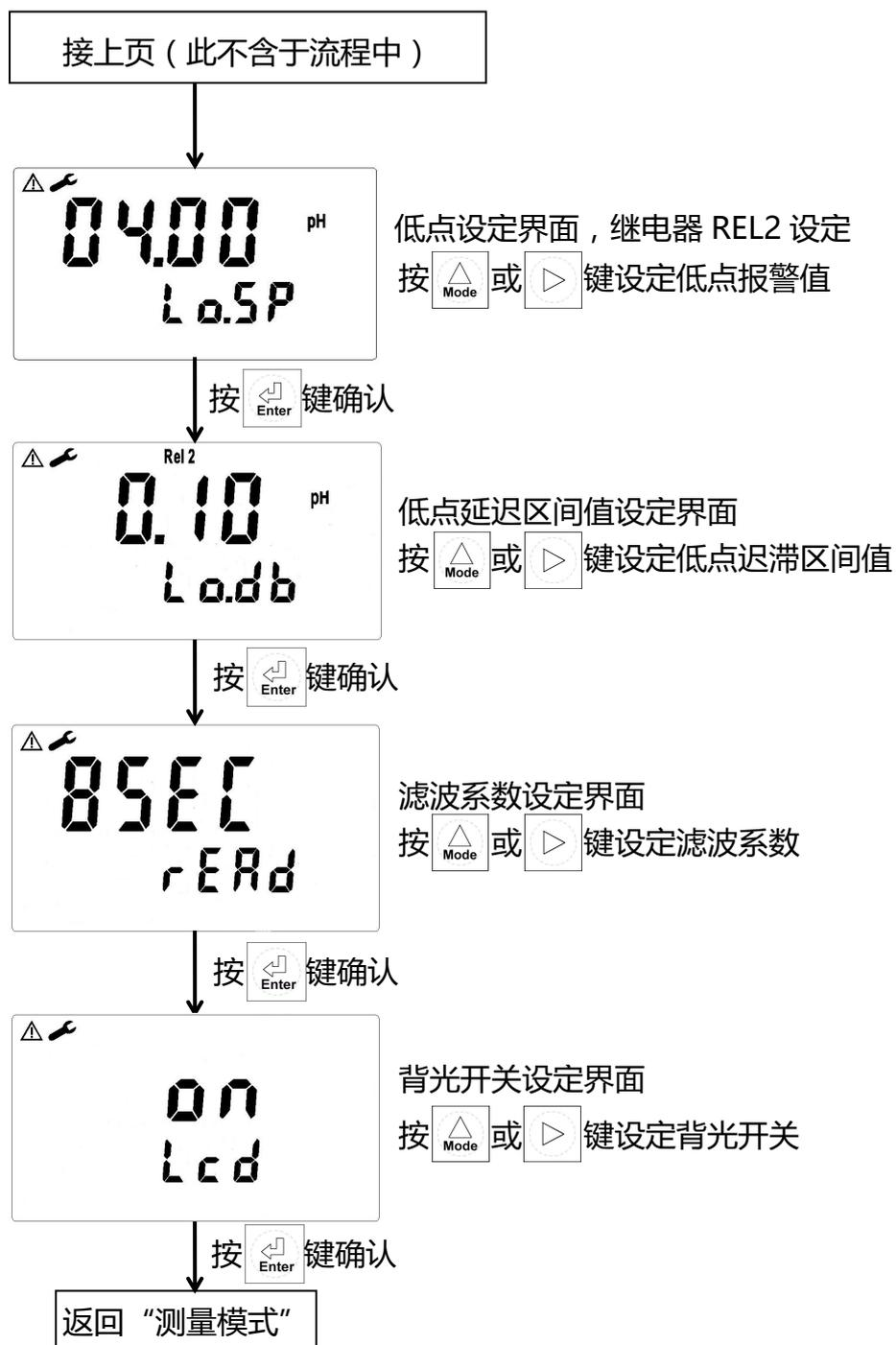
说明：至此 PH 的控制参数全部设定完成，在设定过程中任何一步，都可以按
